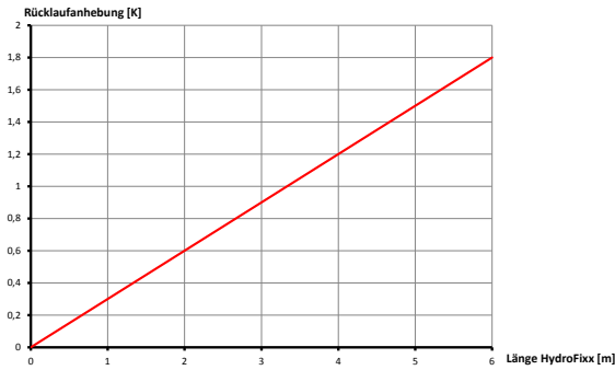
Wärmeübergang zwischen Vor- und Rücklaufkammer
